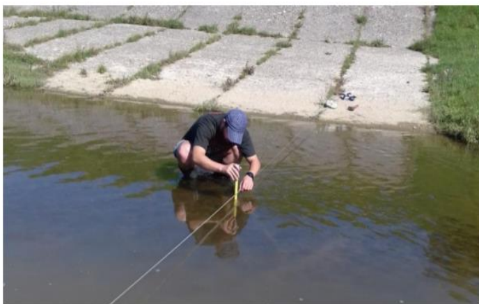
Slika 2-6. Mjerenje dubine profila i definiranje točaka mjerenja brzine
